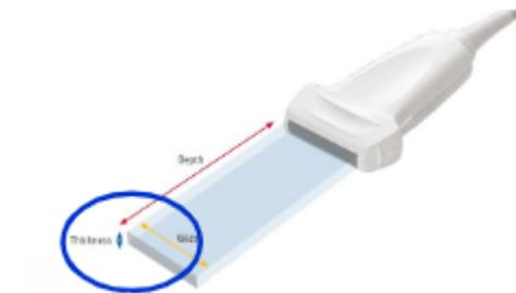
La forma del haz del transductor está relacionada con la **huella de transductor**. En cuanto **más alta es la frecuencia mejor es la resolución de imagen**, pero **menos profundidad** permite alcanzar, y viceversa.
